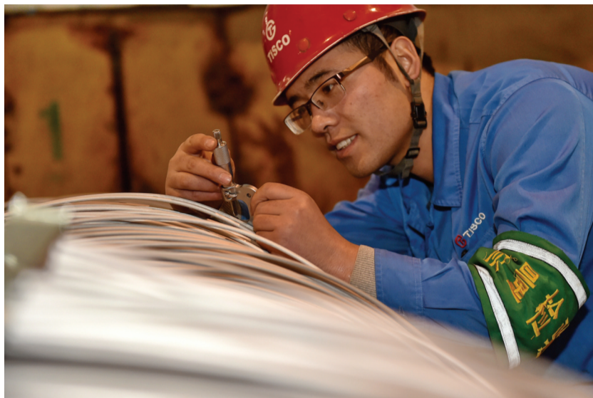
太钢集团的质检人员在检验“笔尖钢”钢丝的质量。 新华社发
