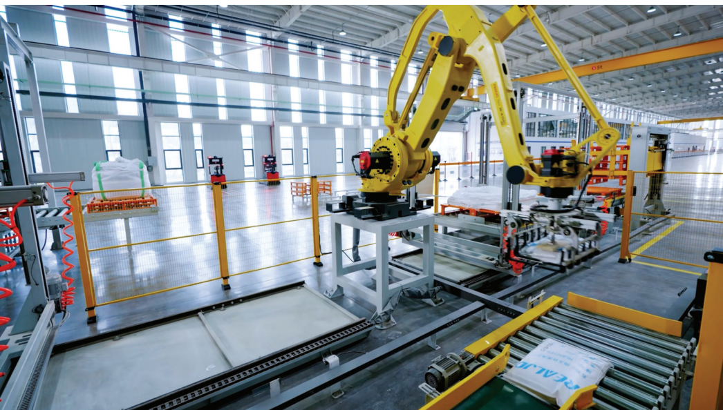
图为生产车间自动化包装设备正在对不定形产品开展封装作业。
