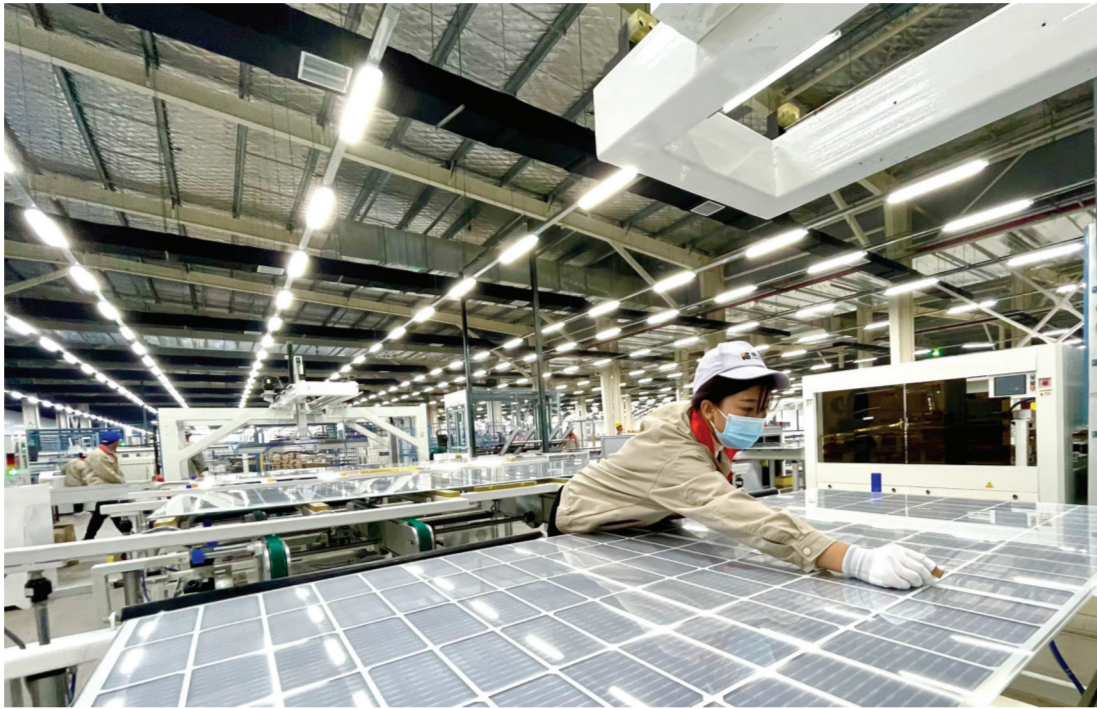
凤阳瞩目能源科技有限公司员工正在检验光伏组件。陈华斌摄
