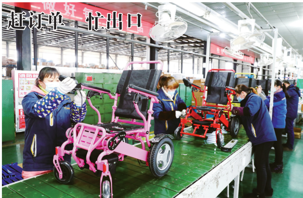
2月2日,明光市经开区安徽百合医疗器械有限公司装配车间,工人正在装配春节前出口美国的2000台电动便携轮椅。该公司研制开发的全碳纤维结构轮椅系列产品获得市场好评,去年在疫情影响下业绩仍保持稳步增长,实现出口创汇3000万美元;2021年伊始,新接出口欧美轮椅订单6000台。
